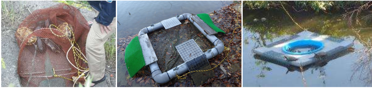
図2. もんどり型罟で捕獲する様子(左), 浮島型罟(中央), 軽量化した浮島型罟(右)
